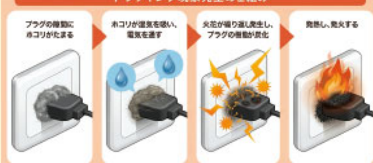
トラッキング現象発生のおこり
