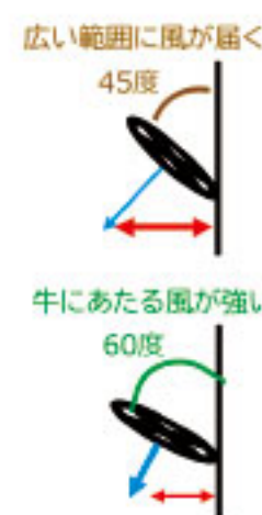
図3 送風機の設置角度による違い
