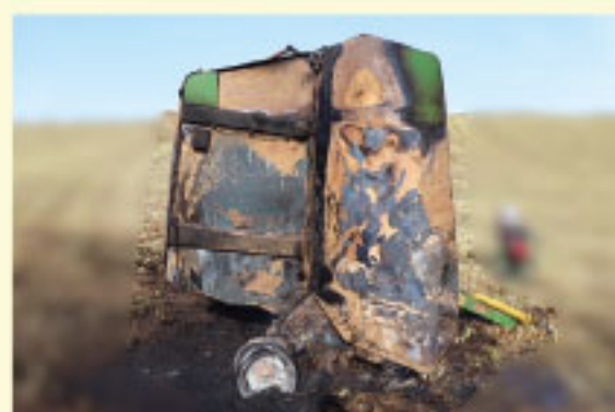
(写真) 作業中にロールペラーの駆動ロール周辺から出火し延焼した事例
