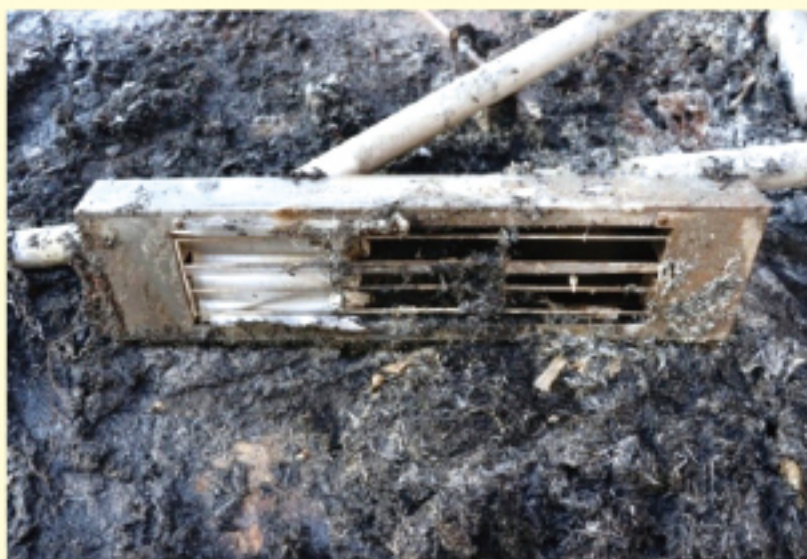
(敷き藁に落下したカーボンヒーター)
