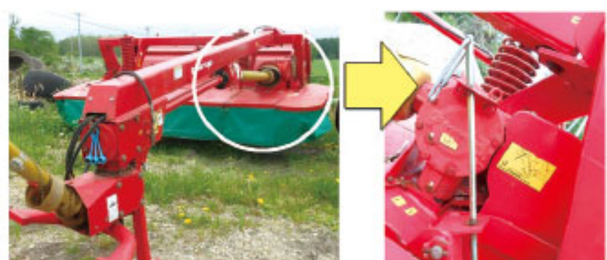
写真1 カッターバーの高さ調整(角度調整)をおこなうハンドル部分(メーカーにより異なります)
