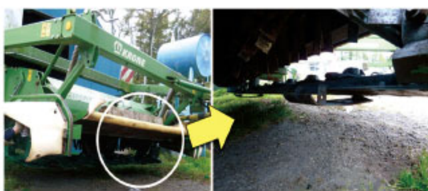
写真2 ハイスキップの設置によるフロートイング(高さ)の調整
