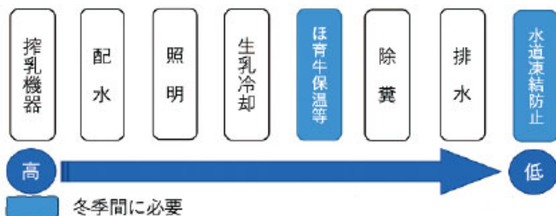
図1 電力が必要な機器の稼働優先順位の例
