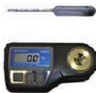
写真1 比重計(上)、デジタル糖度計(下)
